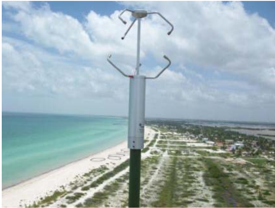
Equipo de medición de parámetros meteorológicos con anemómetros sónicos (5 a cada 10 m)
