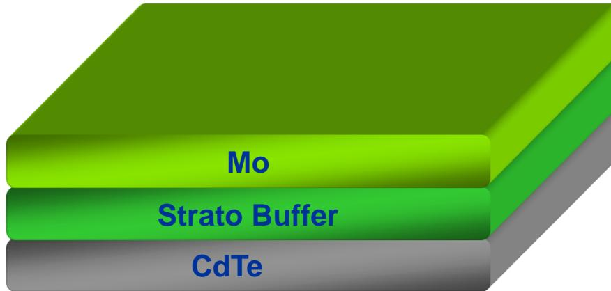
***Sul CdTe è depositato uno strato buffer per sputtering ad una temperatura del substrato di 250 C, senza alcun etching sulla superficie del CdTe.***
