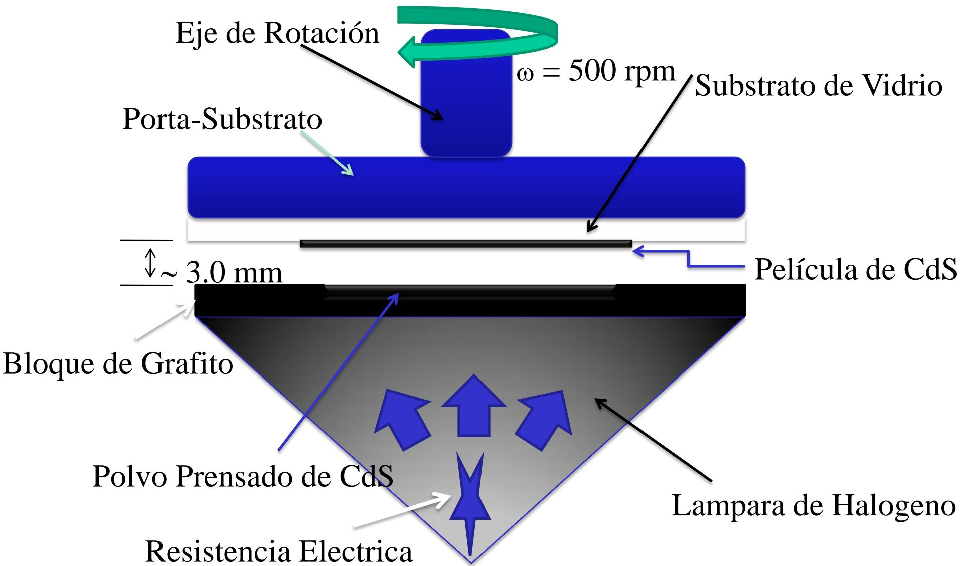
**Visión esquemático de la Técnica CSS con giro de substrato**
